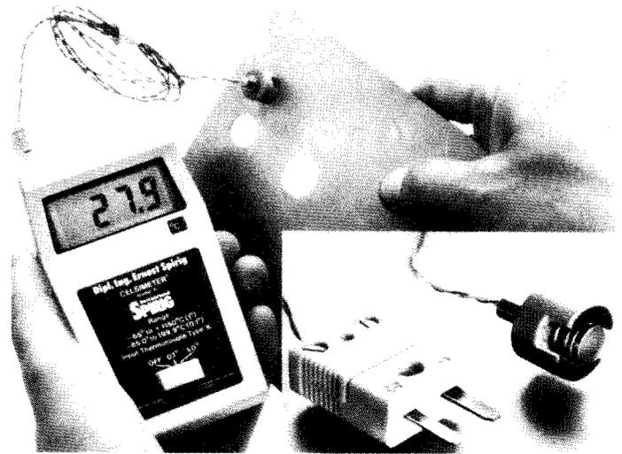
Celsiprobe-Sonde zum Messen von Oberflächentemperaturen, angeschlossen an das handliche Digital-Thermometer „Celsimeter“ mit umschaltbarer Auflösung.
