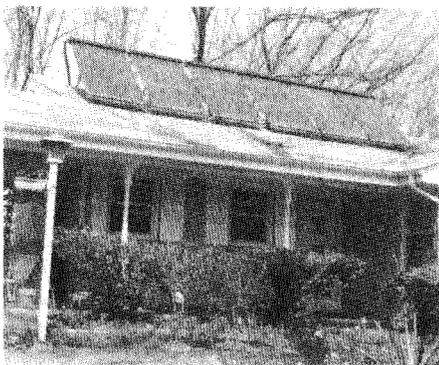
Eine Kollektorbatterie zur Raumheizung auf dem Dach eines Wohnhauses in den USA.
