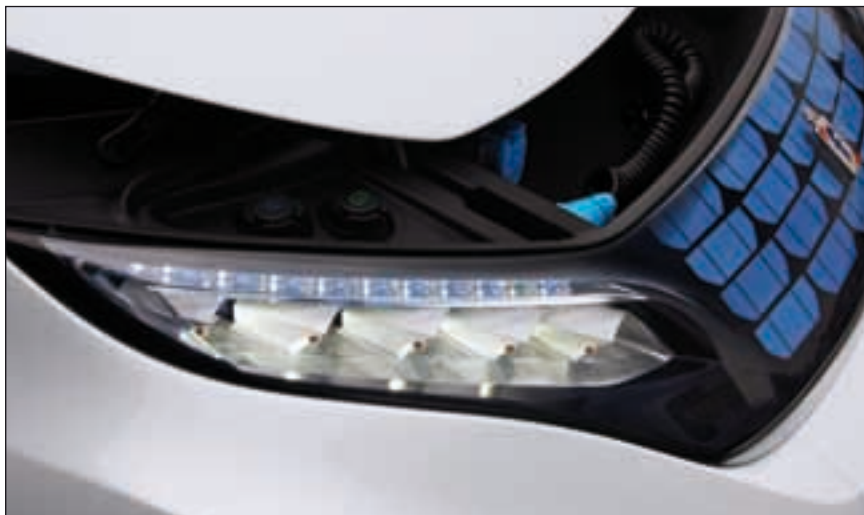
Bild 5: Eine nahezu perfekte Lösung bietet der Pininfarina BO. In einem breiten Ladekabelfach, das von den Seiten als auch von vorne optimal zu erreichen ist, wartet das bereits angeschlossene Ladekabel griffbereit in ergonomischer Höhe.
