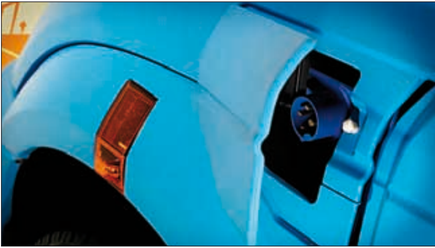
Bild 1: Der Think City hat eine Ladebuchse auf der Fahrerseite.
