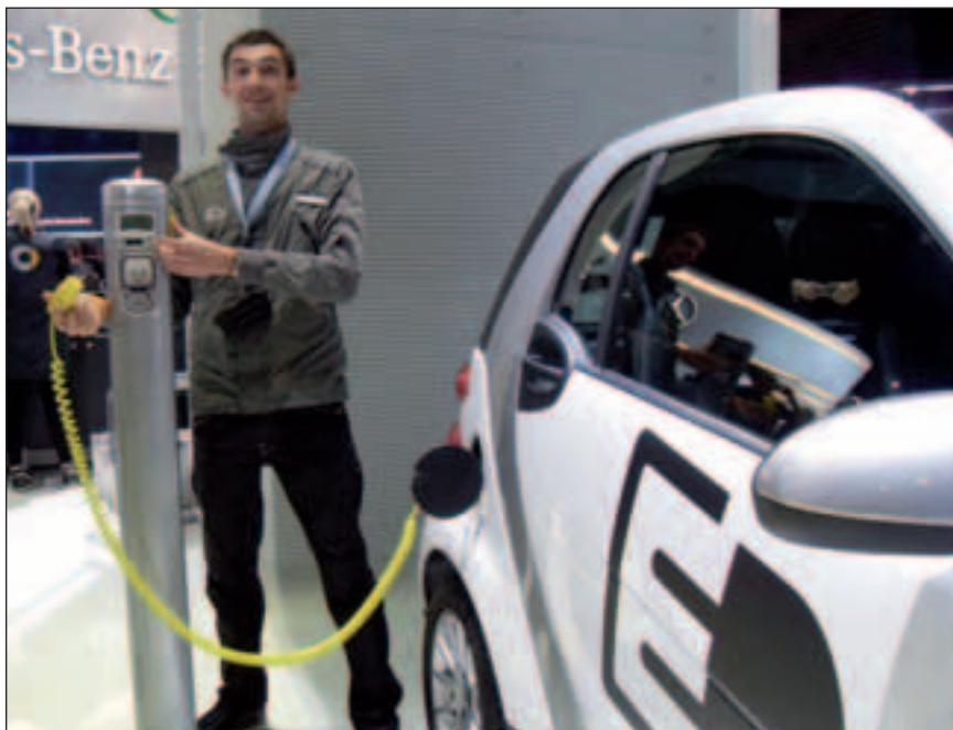
Bild 7: Aufgrund der geringen Kosten und der großen Flexibilität wird die Kombination aus Stromstelle (der Ladesäule) und Ladekabel mit Steckkontakt bis auf weiteres die dominierende Infrastruktur für individuelle Elektroautos bleiben. Automatische Systeme scheitern am Preis und der Tatsache, dass auch im ordentlichen Deutschland auf den Parkplätzen keine mathematisch exakte Ordnung, sondern eher geregelt Chaos herrscht.
