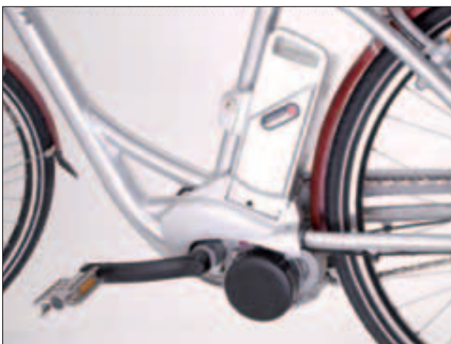
Bild 5: Der Wechselakku eines Pedelecs ist klein, handlich und lässt sich einfach tauschen bzw. zur Ladestation tragen.
