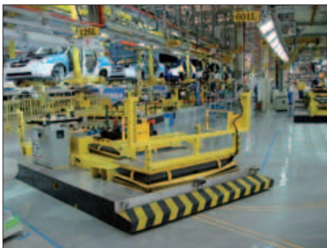
Bild 3: Autonome Industriefahrzeuge werden durch Induktionsschleifen gelenkt und gleichzeitig mit Energie versorgt.
