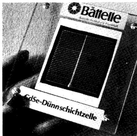
Bild 1. Demonstrationmuster einer CdSe-Dünnschichtsolarzelle
