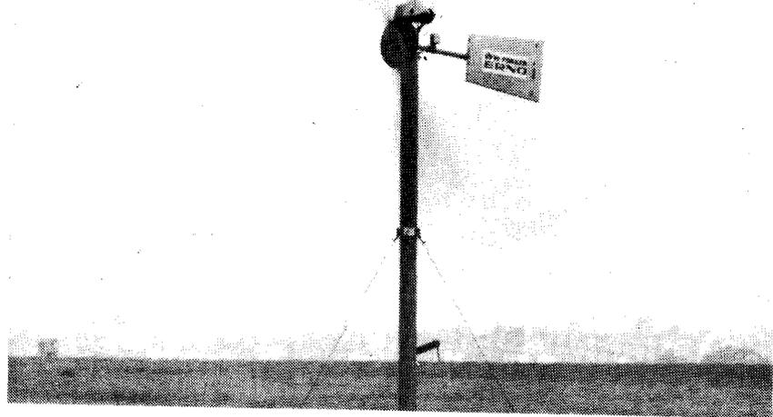
Windkonverter 50 bis 500 W, seit drei Jahren bei der ERNO-Raumfahrttechnik GmbH, Bremen, in Betrieb, mit dem Ziel, eine sehr einfache Bauweise für Kleinanwender zu erreichen; Rotordurchmesser 2,2 m, min. Masthöhe 3,5 m
