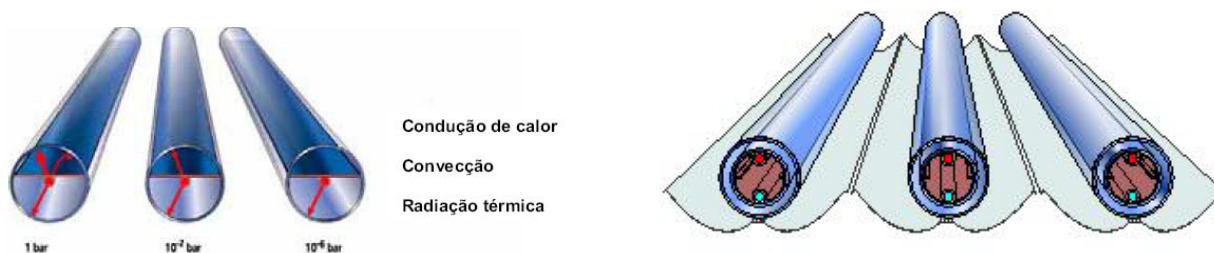
Fig. 6 O princípio do isolamento térmico de vácuo e corte longitudinal cruzado do tubo de Sidney (CPC)
