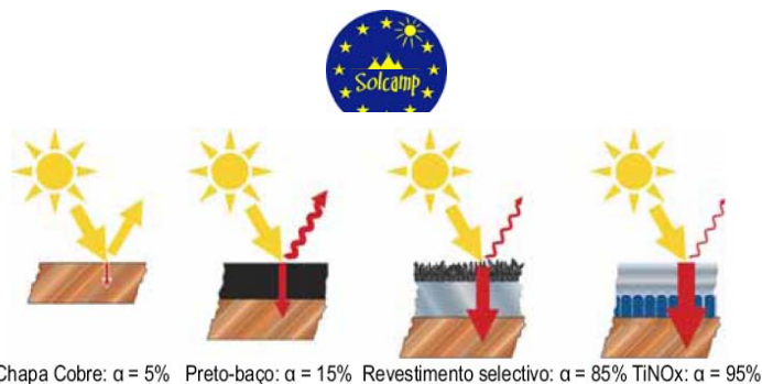
Fig. 5 Comportamento de absorção e emissão de superfícies diferentes
