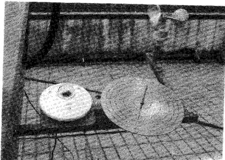
Globalstrahlungs-pyranometer, Winkelanzeige und Windmesser
