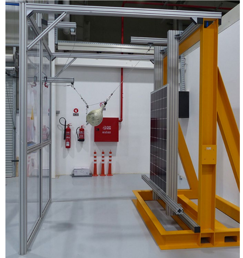
Pendelschlagversuch nach MST 32 [Foto: www.pse.de ]
