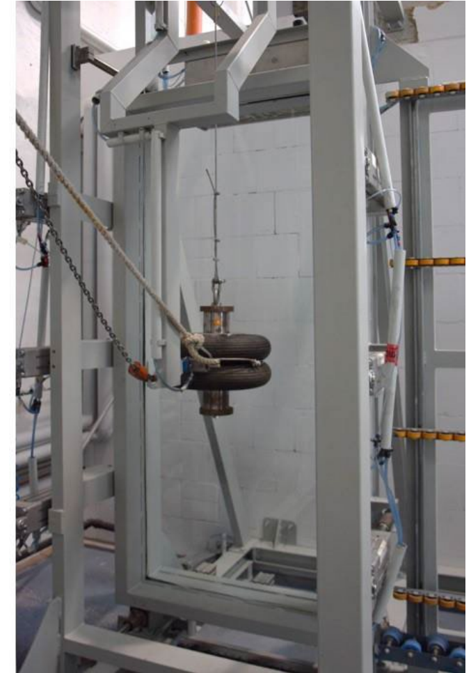
Pendelschlagversuchsaufbau mit Doppelreifen und Stahlkugel nach DIN EN 12600 der TU Siegen
