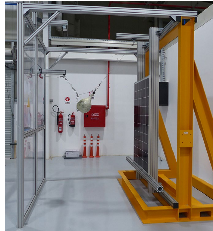
Pendelschlagversuch nach MST 32 nach Norm [Foto: ww.pse.de]
