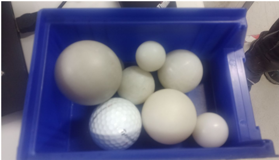
TÜV Rheinland: Größenvergleich Hagelkörner für Tests mit Golfball
