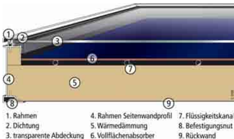
Abbildung 8: Schnitt durch einen Flachkollektor (DGS, 2008)
