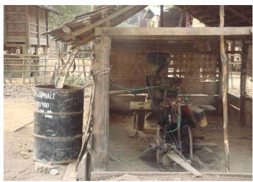
រូបទី ១: ម៉ាស៊ីនភ្លើងសំរាប់ម៉ាស៊ីនកិនស្រូវ
