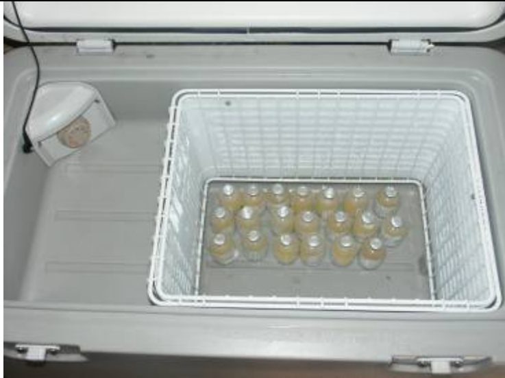
ຕູ້ເຢັນແຊ່ຢາວັກຊິນ ໄຟຟ້າແສງຕາເວັນ (ດ້ວຍຄວາມເອື້ອເພື່ອຈາກບໍລິສັດຊັນລະບົບ)
