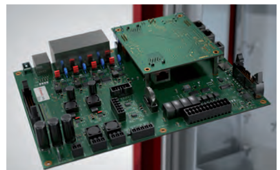
Innenleben und Steuereinheit eines SENEK-Home-Speichers, der mit Akku-Kapazitäten von 1 bis 10 kWh angeboten wird
