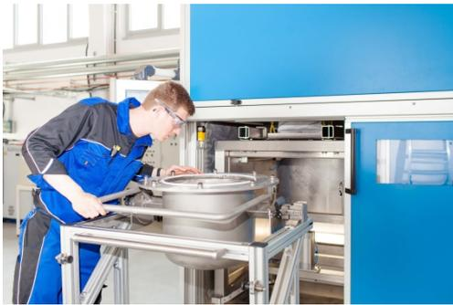
Die elektrohydraulische Fragmentierungsanlage erlaubt das Recycling von wertvollen Materialien ohne Chemikalien.
